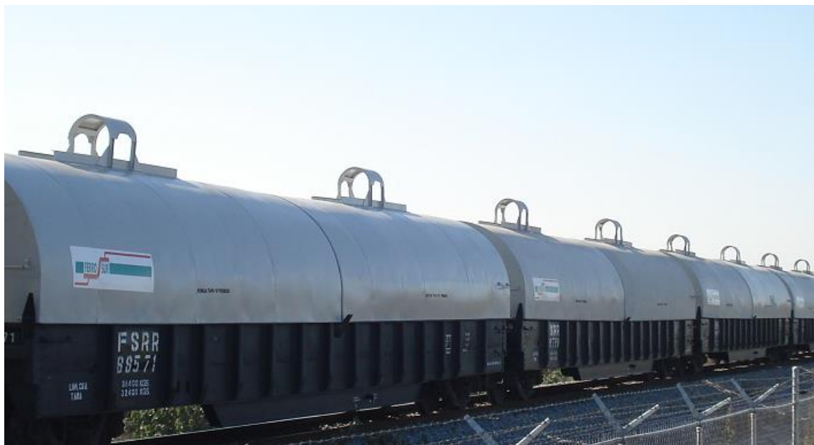
FERROSUR. Conversión góndolas a Coil Cars para movimiento de bobinas de acero.
