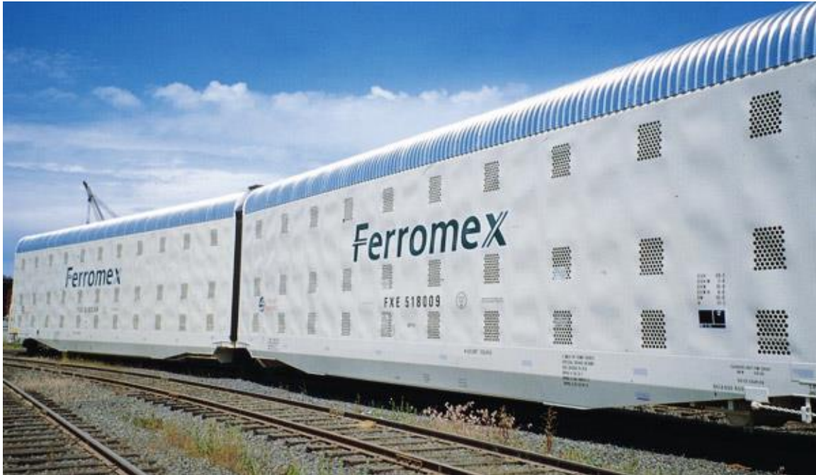
FERROMEX. Equipo trinivel para transporte de vehículos armados
