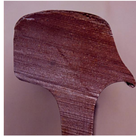
Riel con desgaste lateral excesivo
