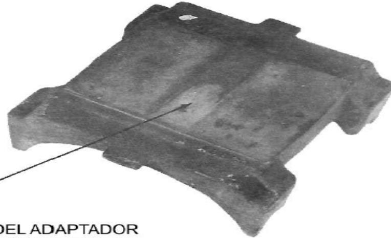
CUANDO LA CORONA DEL ADAPTADOR TENGA DESGASTE AL GRADO QUE EL BASTIDOR LATERAL DEL TRUCK HAGA CONTACTO CON CUALQUIER PARTE DE LA RANURA DE DESAHOGO, ENTONCES EL ADAPTADOR DEBERÁ SER DESCHADO
