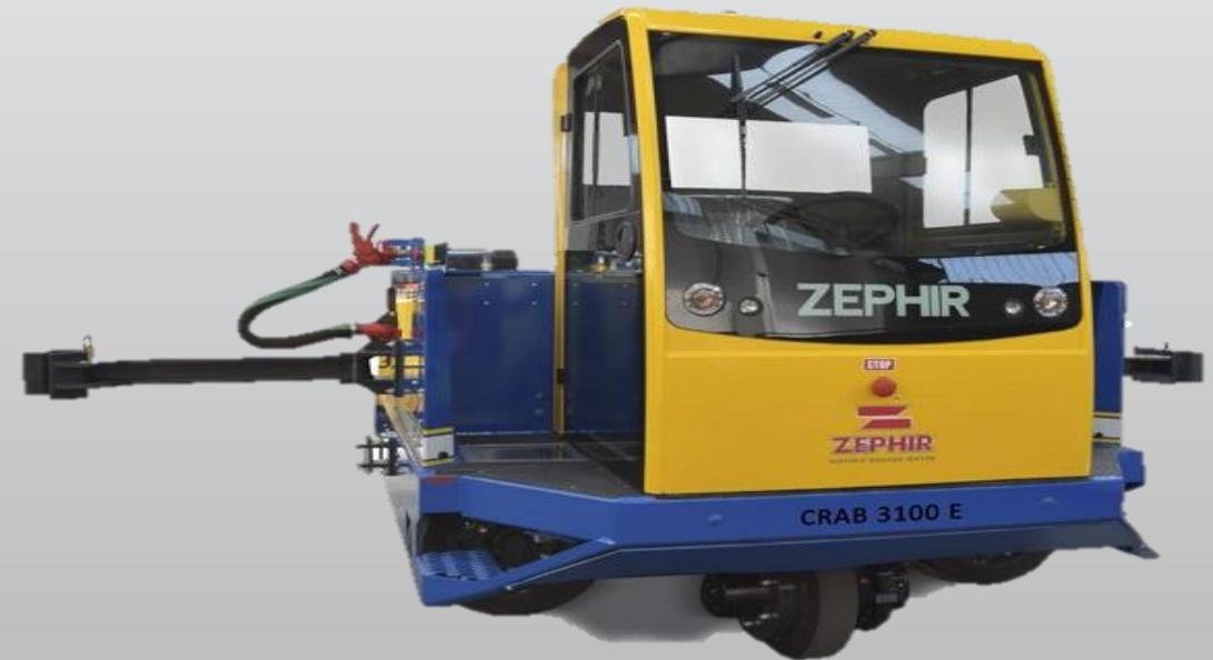
Fuerza tractiva: 8,100 Lbs. (36kN) para una capacidad máxima de arrastre de 730 Toneladas en condiciones óptimas de vía (vías secas a nivel y rectas).
