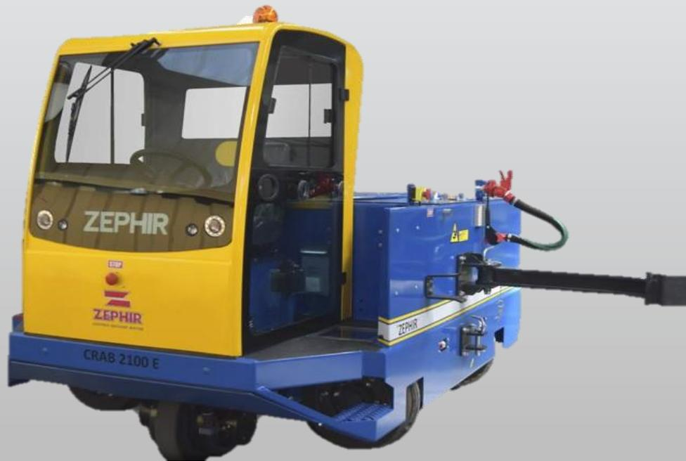
Fuerza tractiva: 5,850 Lbs. (26kN) para una capacidad máxima de arrastre de 520 Toneladas en condiciones óptimas de vía (vías secas a nivel y rectas).
