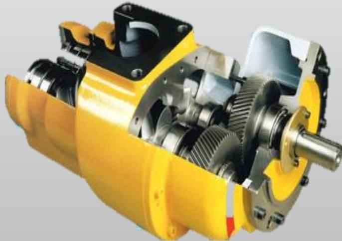
Compresor tipo rotatorio de 100 pies cúbicos/min para frenado de tren
