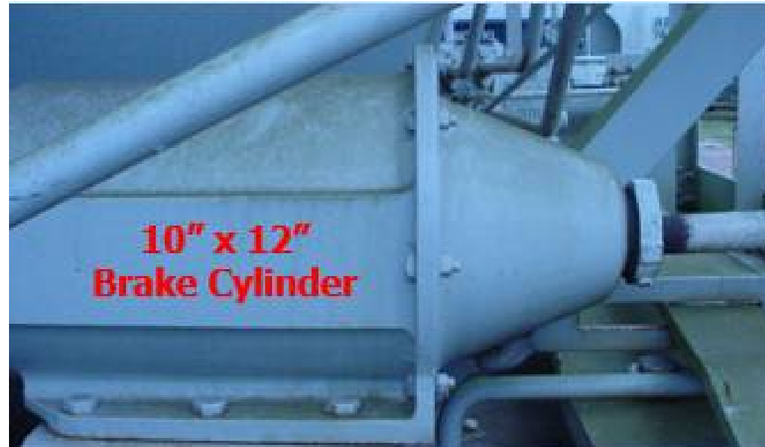
Cilindro de freno montado en el cuerpo en posición de freno liberado
